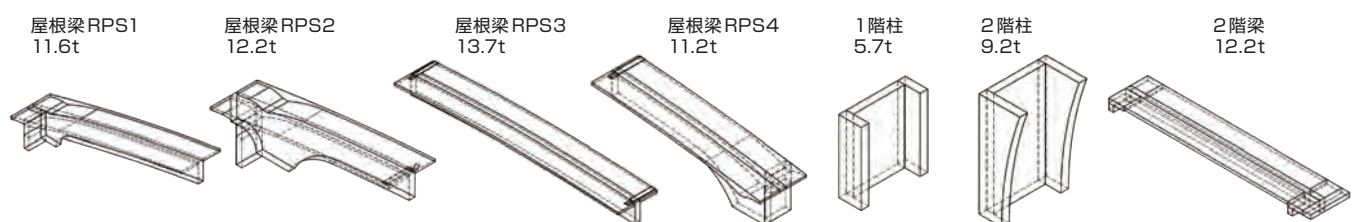
図-1 PCaPC造部完成予想パースおよびプレキャスト部材3D図
