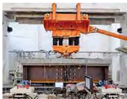
写真-8 輪荷重走行試験状況
