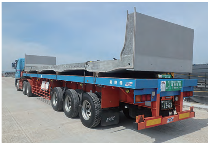
写真-2 壁高欄一体型プレキャストPC床版
