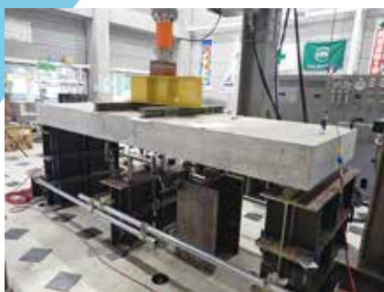
写真-4 静的載荷試験
