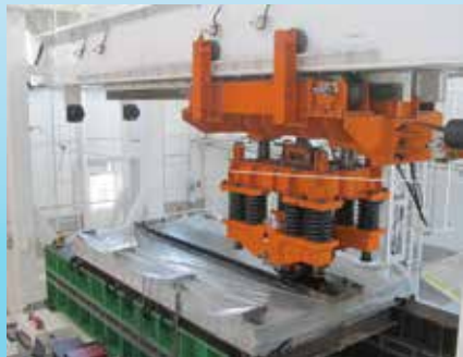
写真-3 輪荷重走行試験
