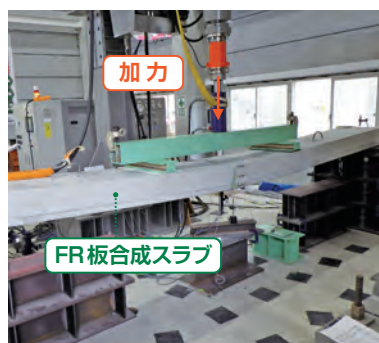
写真-3 曲げ耐力確認実験
